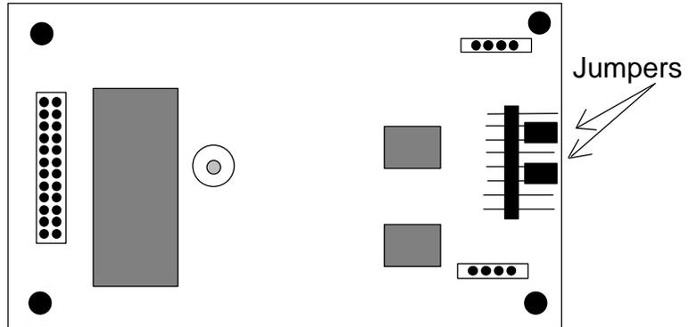
Figure WAN-2. 811 DSX/CEPT Module (Top View)
