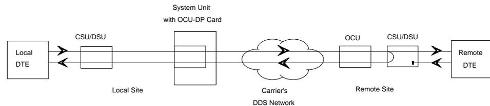
**Figure OCU-7. OCU Remote Loopback (csu-n option)**
